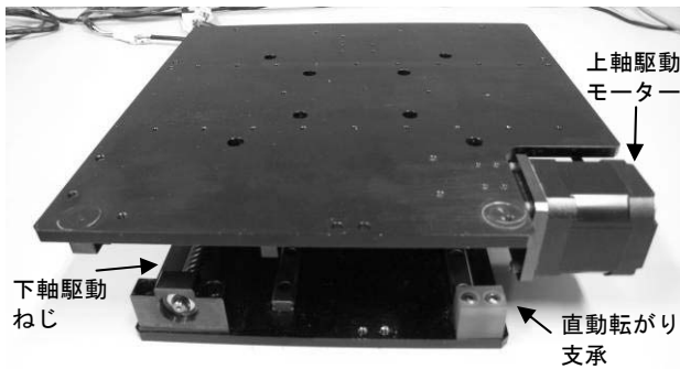
写真 3 卓上水平 2 軸振動台の外観
