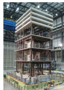
図3 E-ディフェンスでの超高層建物実験
