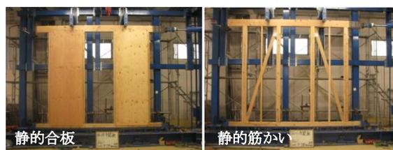
図 3 静的性能評価試験の試験体全景
