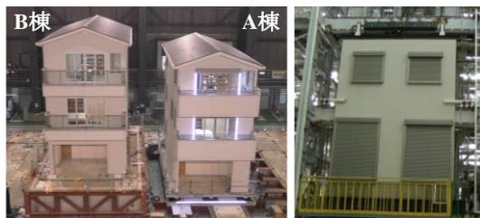
図 1 試験体全景(左:実大実験, 右:構面試験)
