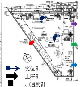
図2 免震層平面図・計測配置
