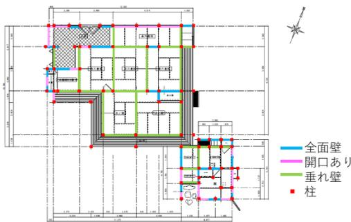
図1 壁・柱の配置
