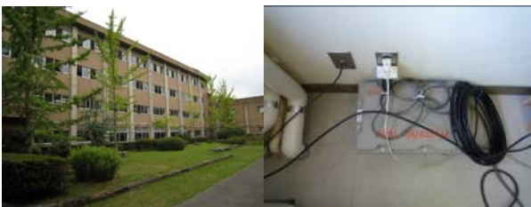
写真2 観測対象の高校校舎外観と強震計設置状況
