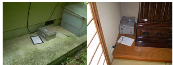
写真3 一般家屋の強震計設置状況
