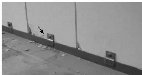
図 13 超大変形実験後の損傷
