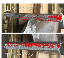
図 3 試験体 3 溶接欠陥部
