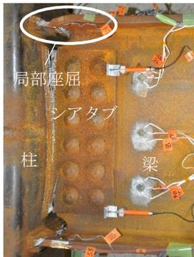
写真2 試験体2実験後
