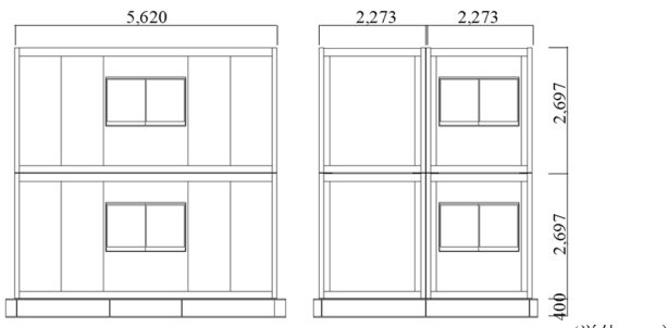
図 1 実験用 2 層建築 (試験棟) の立面図 (単位 mm)
