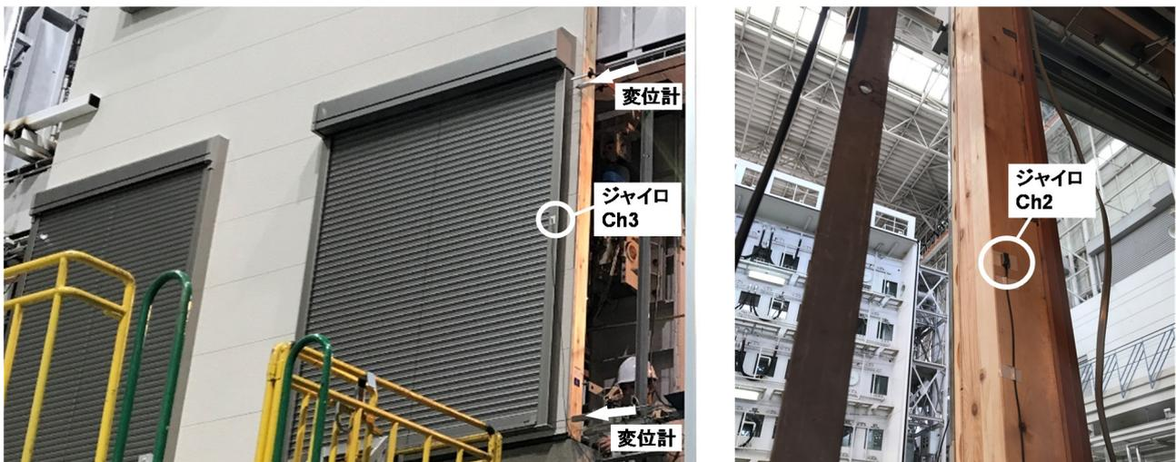
図7 ジャイロの設置状況 (左: シャッターガイドフレーム正面, 右: 柱裏面)
