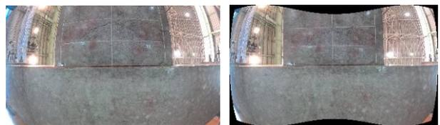
図8 区間A 画像の樽型収差とその補正例
