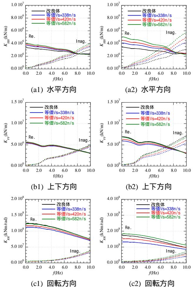
図4 改良深さ  $L$ 、 $V_{Seq}$  とインピーダンスの関係
