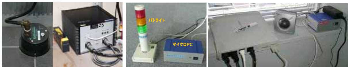
図 2-4 インターネット接続による振動・映像のリアルタイムモニタリングと地震警報システム
