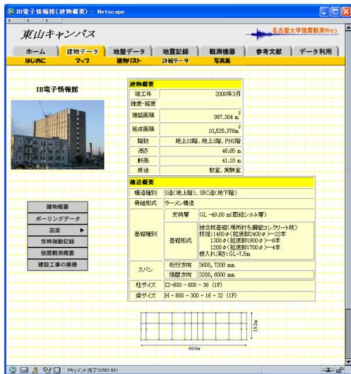
図 10.3 建物の詳細データ (建物概要と構造概要)
