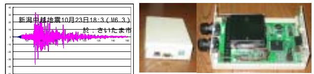
図 8 廉価地震計の外観と普及型強震計との波形比較
