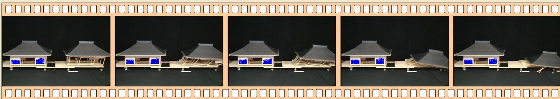
宮大工製作による精巧社寺模型、スローモーションによる映像で倒壊の様子を的確に再現！
