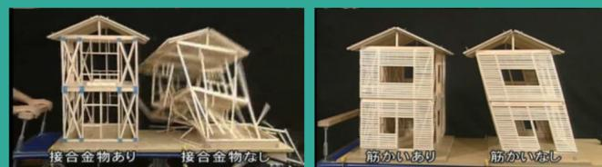
木造住宅の被害例 構造から、金物や配置など
