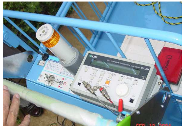
ファンクションジェネレータで速度波形を入力
