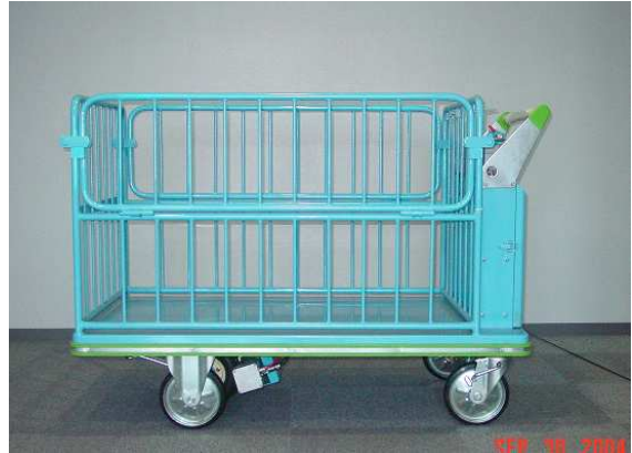
側面写真、右端の箱が制御、駆動部
