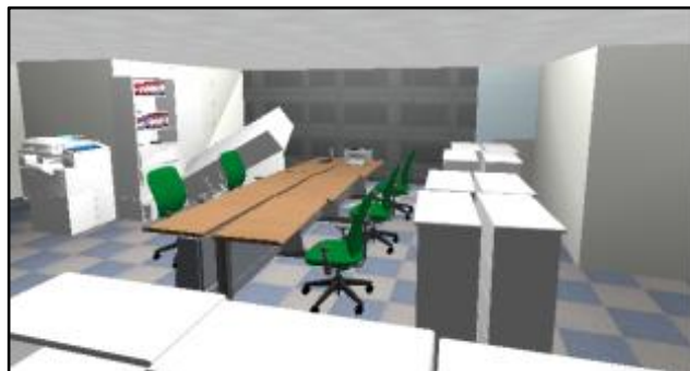
図5 E-ディフェンス実験の室内被害を再現したシミュレーション結果 謝辞
