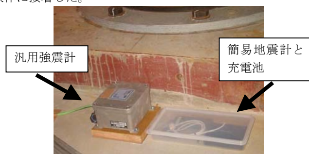
図2 汎用強震計(左)と簡易地震計(右)の設置状況
