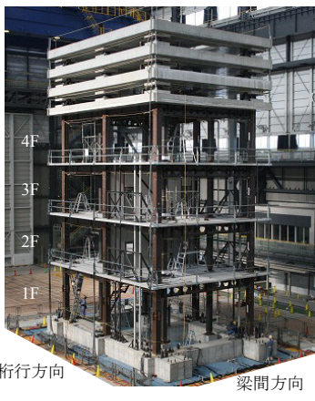
図-2 震動台上試験体全景
