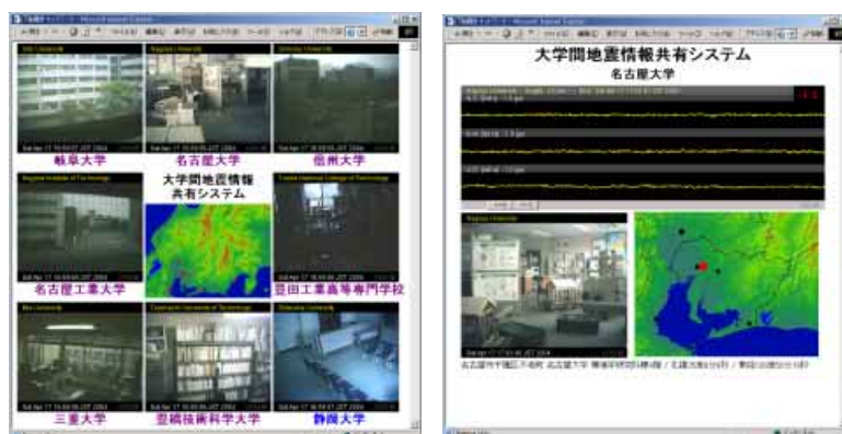
図2 ネットワークカメラと地震計のデータ表示 (左：全地点映像、右：各地点振動と映像)
