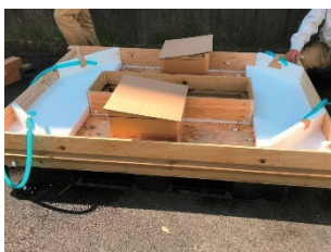
写真1 形状②③の模型検証
