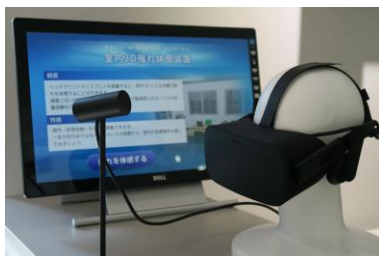
図4 HMDを用いた没入型体感システム
