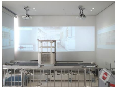
図1 長周期ロングストローク振動台+背景画像同期システム
