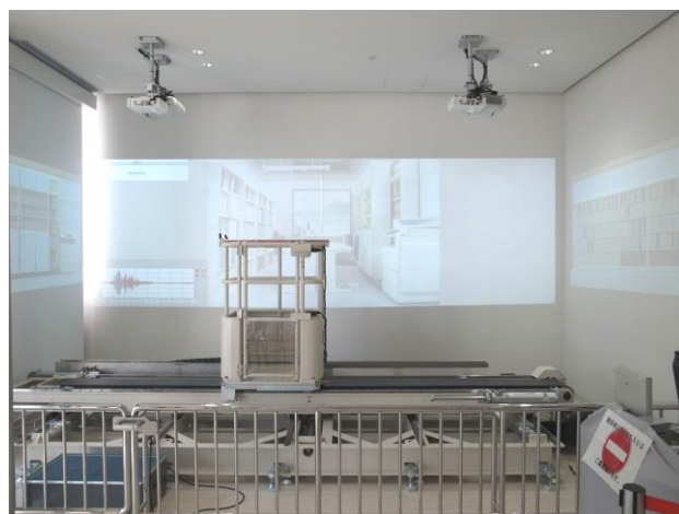
図-7 長周期・ロングストロークの2軸振動台
