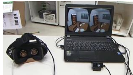
図-5 HMD を用いた高精度仮想現実震動体感ソフトウェア
