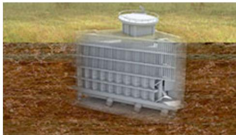
ビルが地盤、最上階の施設が建物の役割を果たし、リアルな地震の実験を行うことができる「減災館」
