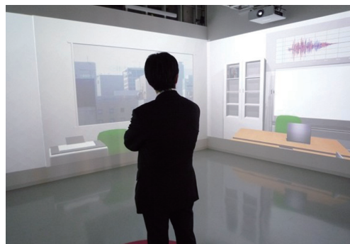
【図3】(上)減災館 屋上振動体感室建物~天井の円形部分には太陽光パネルがあり非常時の電気供給源となる。右下の赤い設備は建物を揺らす駆動装置 (下)屋上振動体感室内部。高層建物の中で巨大地震に遭遇した時の揺れを、内壁3面に映し出されたCG映像や音と共に体感できる。大振幅で長時間揺らされるのは、想像以上に恐怖を感じた (出典:インターリスク総研にて撮影)
