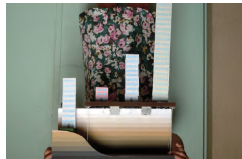
図6 振り子2つを利用した逆さ共振実験
