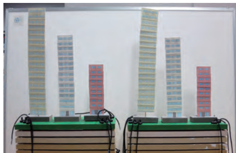
図5 地盤と建物の共振実験
