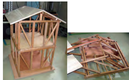
図3 繰り返し倒壊実験ができるピノキオぶるる
