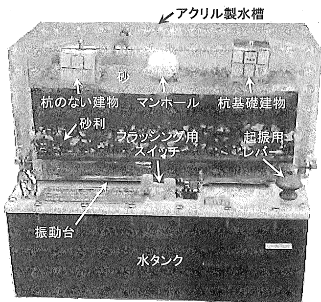
写真7 今回開発の液状化模型
