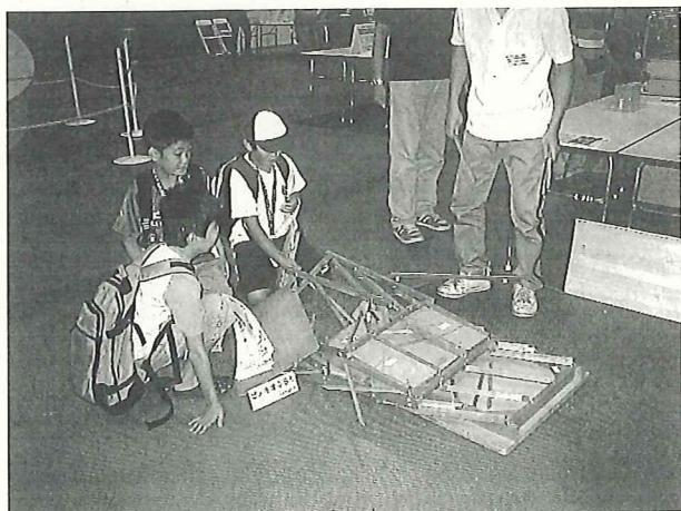
写真1 ピノキオぶるる(木造住宅倒壊模型)
