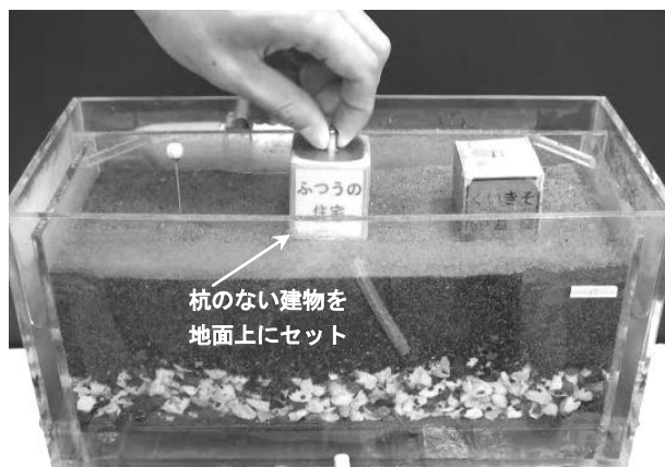
③ 水位が地面より僅かに下がった所で水位低下をストップさせ、杭のない建物を地面上にセットする。
