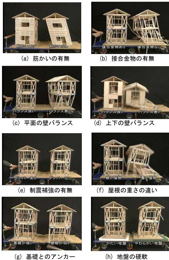
図9 木造倒壊実験模型を用いた実験メニュー
