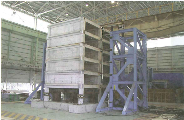
1/3スケール6層ビロティの震動実験(2000年7月) E-Dfenseでは実大、すなわち長さのスケールで3倍の試験体の震動実験が可能になる。
